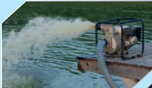
1цилиндровый, воздушное охлаждение, 4-х тактный
