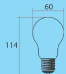
**Лампа светодиодная с датчиком движения**
